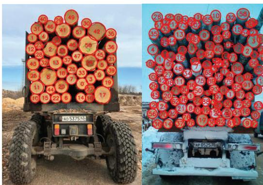
Рис. 1. Анализ количества и диаметров бревен на разных этапах лесозаготовки
